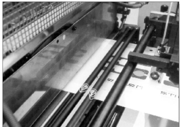
Bild 4: Aktiver Ionisator an einem Schlauchbeutelautomaten
